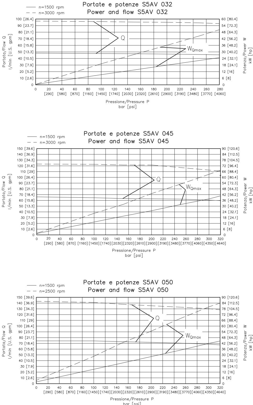
I diagrammi sono rappresentativi della media della normale produzione della Brevini Fluid Power. Le prove sono state eseguite con olio minerale ISO VG 46 a 50°C.
