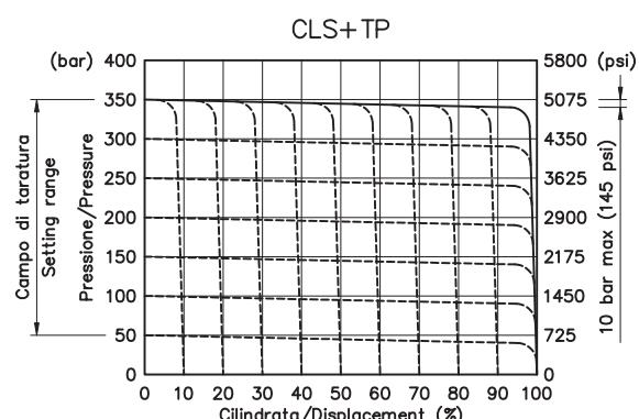
Il regolatore a potenza costante controlla la cilindrata della pompa in funzione della pressione di esercizio in modo che la potenza assorbita dalla pompa non sia mai superiore alla potenza massima fornita dal motore primario.
