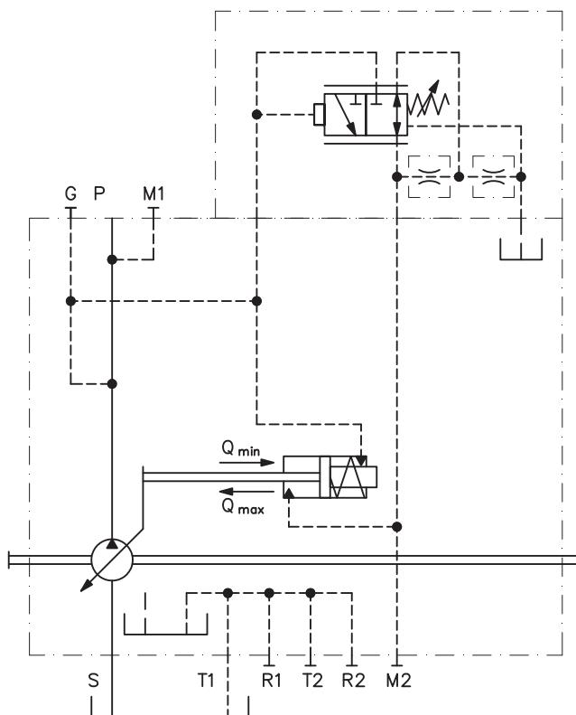
Il regolatore è dotato di un drenaggio interno per il raffreddamento della pompa in condizioni di stand-by. La portata di drenaggio è funzione della taratura del regolatore. I valori medi di drenaggio alle diverse pressioni di funzionamento sono riportati nella tabella seguente.
