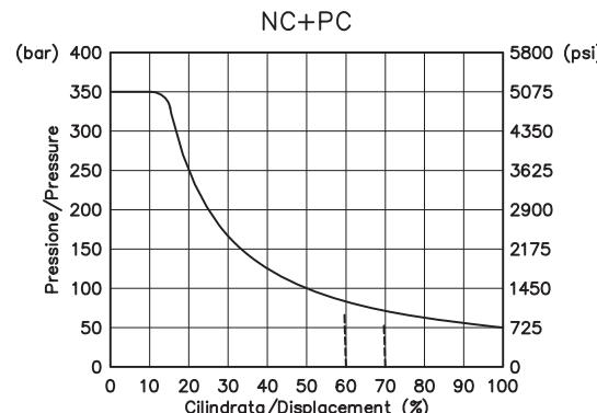
Il regolatore a potenza costante controlla la cilindrata della pompa in funzione della pressione di esercizio in modo che la potenza assorbita dalla pompa non sia mai superiore alla potenza massima fornita dal motore primo.
